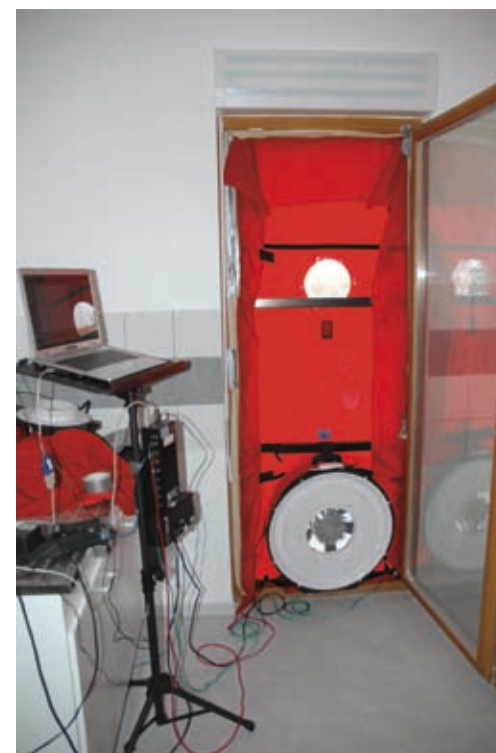
Illustration du test BlowerDoor (porte soufflante)
