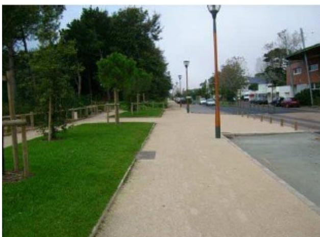
Sable stabilisé préconisé sur les pistes mixtes cycles/piétons
